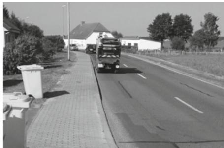
Wann man das Fahrzeug im Einsatz sieht, glaubt man im ersten Moment, es handelt sich um den jedem doch bekannten „Multicar“, aber dieses Fahrzeug ist ein „Rasko“. Bei starker Trockenheit befeuchten Düsen im vorderen Fahrzeugteil das zu kehrende Gebiet, um so Staubbildung zu vermeiden. Der
