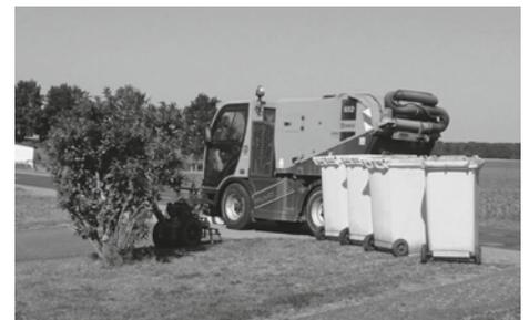
Wassertank des Fahrzeugs hat ein Fassungsvermögen von 300 Liter. 29 m<sup>3</sup> Schmutz kann durch das Gerät aufgenommen werden. Je nach Verschmutzung können verschiedene Bürsten eingesetzt werden, so z. B. für die Bekämpfung von Unkraut in den Ritzen der Gehwege und Rinnsteine. Eine derbe Metallbürste, welche als Einsatzbürste für den Wildkrautbetrieb gedacht ist, kann auch montiert werden.
