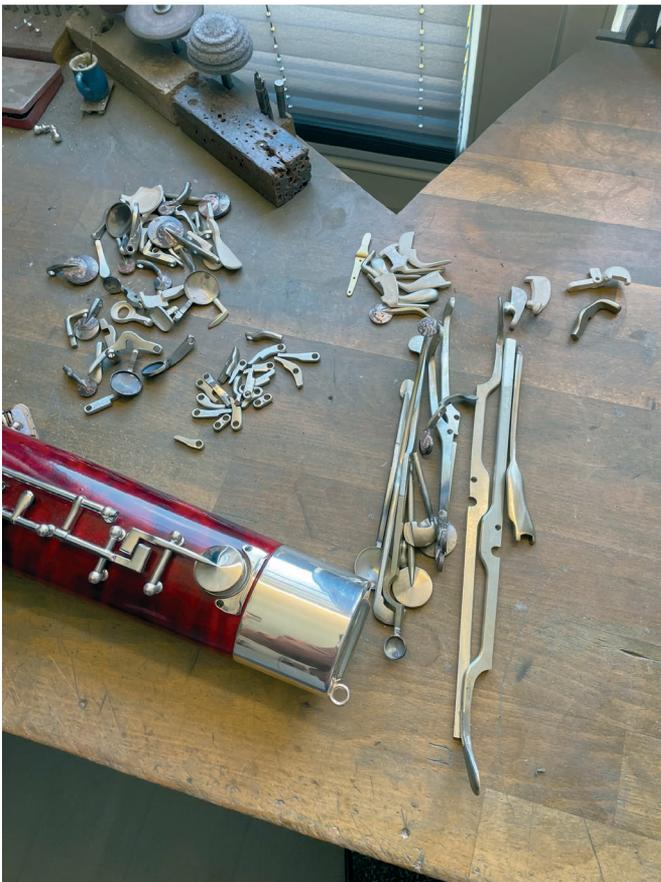
Zum Teil bereits bearbeitete Kleinteile der Mechanik
