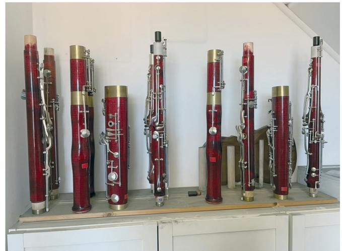
wieder nach Hessen verschickt, wo ein Fertigmacher die restlichen Arbeiten ausführt, indem er winzig kleine Korkunterlagen für einen leisen Gang der Bedienelemente einfügt und dünnes Ziegenleder auf die Unterseite der Klappen bringt, damit die Tonlöcher wirklich dicht verschlossen sind. Und natürlich dürfen zum Schluss auch das Mundstück, der sogenannte S-Bogen, sowie eine perfekte Ausstimmung des Instrumentes nicht fehlen.
